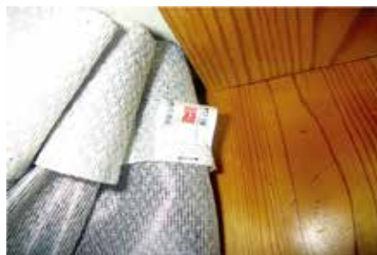
焼損したカーテンの防災物品ラベル
