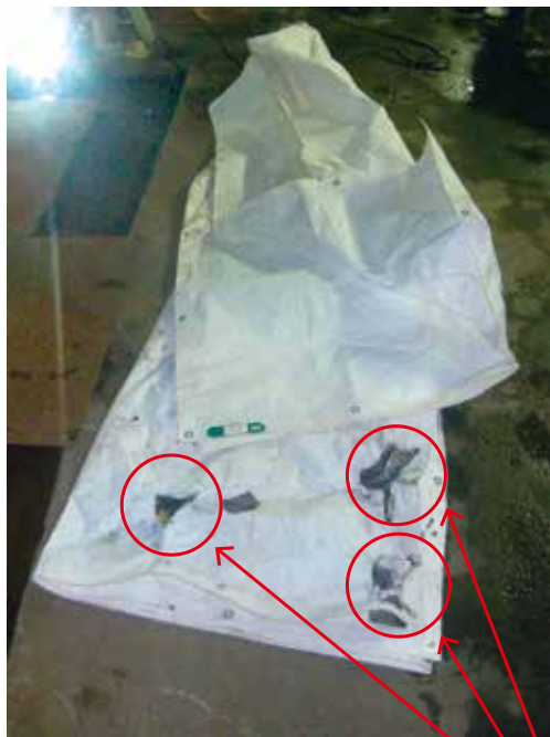
防災シートの焼損箇所
