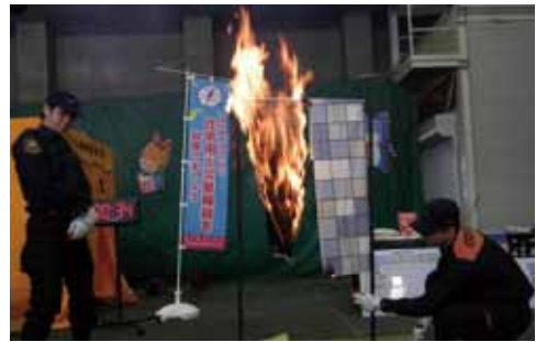
防災品と非防災品との燃え比べの状況
