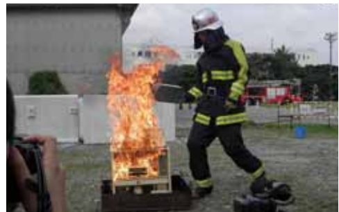
灯油が漏れ激しく燃え上がっている状況
