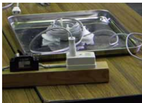
束ねた配線の火災実験の状況
