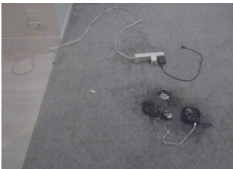
カーペット及びモバイルバッテリーの焼損状況
